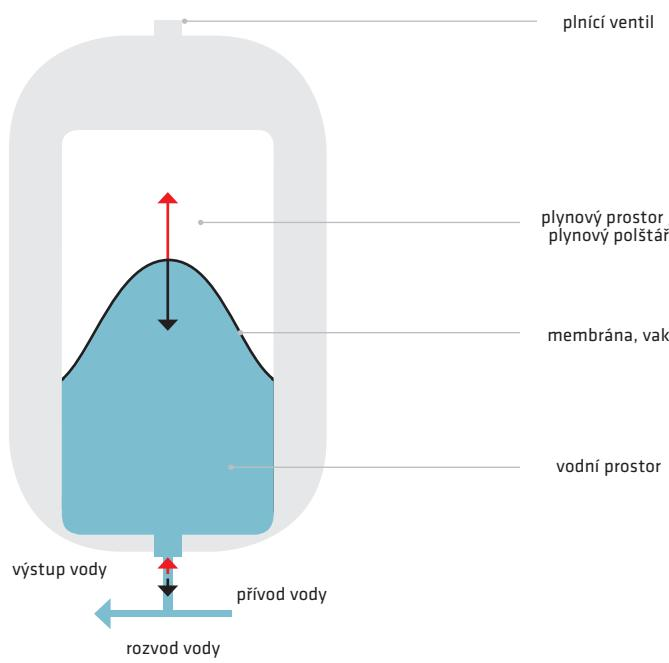
Plynový polštář udržuje hladinu vody zařízení a nastavuje se před samotným naplněním nádoby vodou ze soustavy. S natopením soustavy dochází k nárůstu tlaku spolu s přepouštěním zvětšeného objemu ze soustavy do nádoby. Plynový polštář je stlačován a tlak stoupá. S chladnutím soustavy dochází ke smrštění objemu a snižování tlaku. Voda se z nádoby vrací do soustavy, což vede k uvolnění plynového polštáře a k snížení tlaku.
