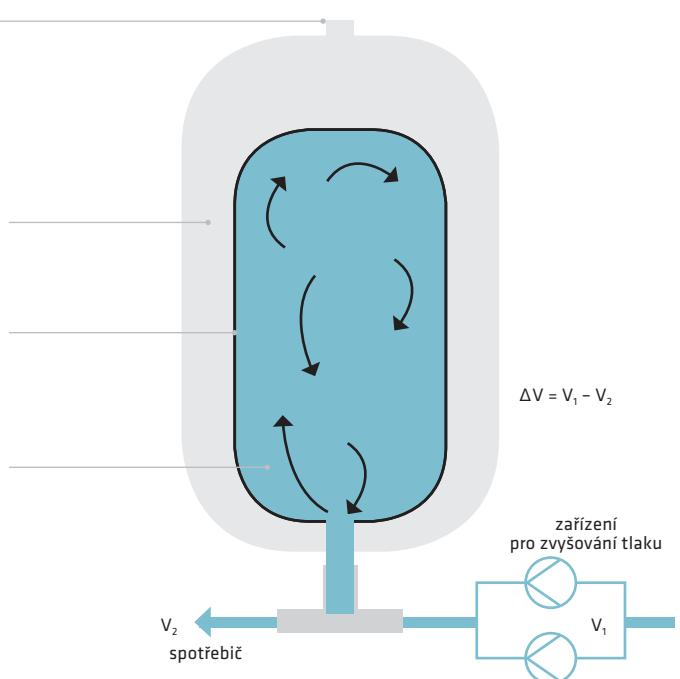
Tlak plynu v plynovém prostoru je nastaven mírně pod zapínací tlak čerpadla. Při podkročení tlak zapínacího tlaku spíná čerpadlo a tlačí vodu do nádoby a soustavy. Odebírá-li se na odběrném místě méně než je průtok čerpadla, je voda akumulována do nádoby tak dlouho dokud se nedosáhne vypínacího tlaku. Začne-li se z odběrného místa odebírat, úbytek vody v nádobě kompenzuje stlačený plynový polštář tak dlouho, dokud opět neklesne tlak pod spínací mez čerpadla a čerpadlo sepne.
