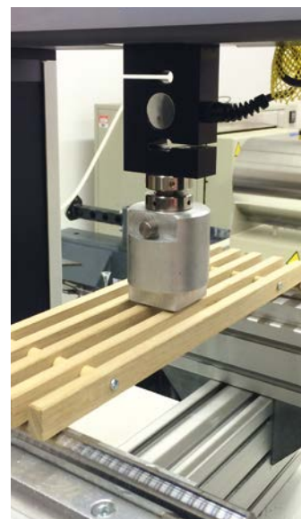
Zkouška zatížení lamel
