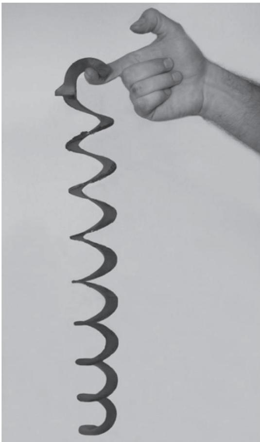
Pokud byl kotel z nějakého důvodu provozován nesprávným způsobem, je možné, že došlo k zanesení turbulátorů, a tím ke snížení průchodnosti spalin. Pokud se tak stane, turbulátory je nutné z kotle demontovat a vyčistit prostor mezi jednotlivými závitů například drátěným kartáčem. Turbulátory je nutné vrátit zpět do trubek, aby se nesnížila účinnost kotle. (Neplatí pro model 15 DPX.)
