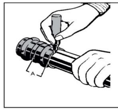
5) Označte na trubce pozici nasunuté tvarovky, abyste se ujistili, zda máte správnou délku zasunutí trubky do tvarovky. Toto označení udává vizuální kontrolu správného zasunutí trubky do tvarovky.
