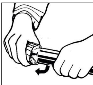
2) Proveďte vnitřní a vnější odstranění otřepů – odhrotování, čímž chráněte O-kroužek před jeho poškozením.
