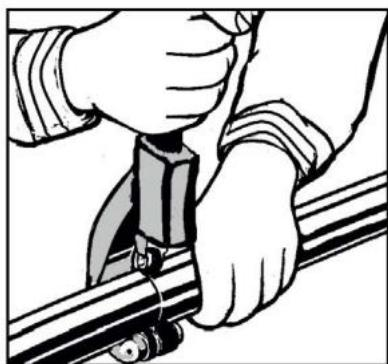
1) Označte si místo řezu a uřízněte trubku kolmo k ose (pomocí řezáku na trubky nebo pilky na železo). Pokud dojde k deformaci trubky musíte ji kalibrovat.
