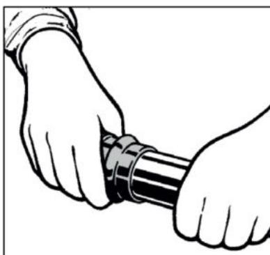
4) Zatlačte za stálého otáčení trubku do tvarovky až nadoraz.
